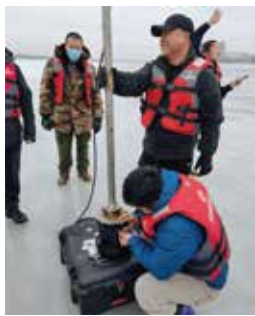
图4 ADCP安装
