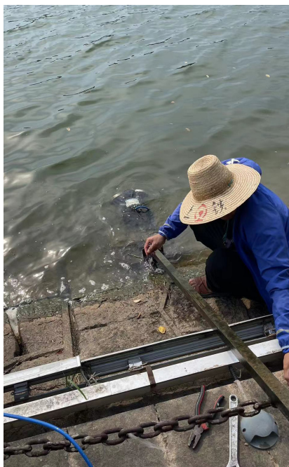
RIV H 系列水平式声学多普勒流速剖面仪安装现场
